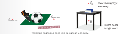
Узајамно деловање тела која се налазе у додиру. Важно: Приказане силе делују на различита тела.
